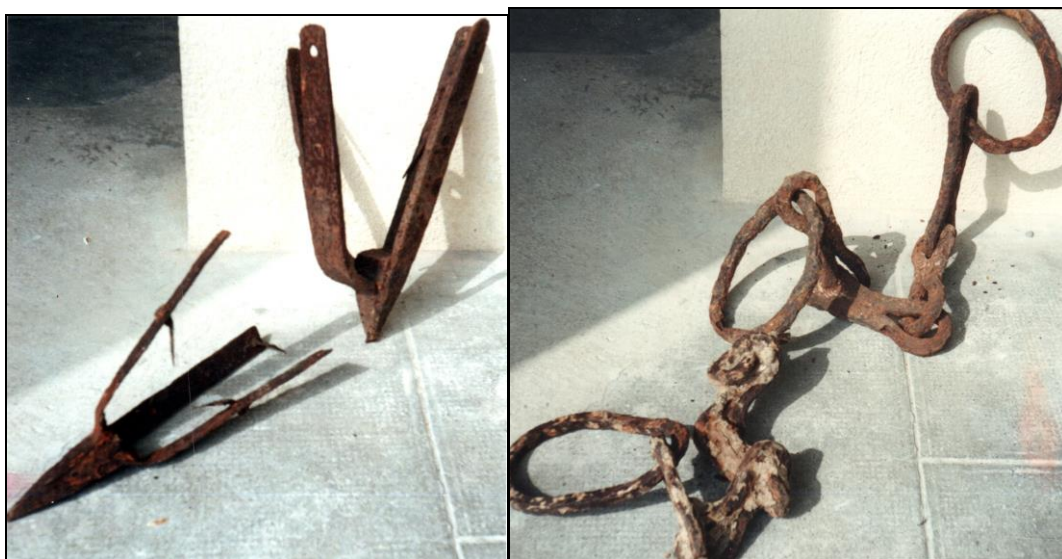
Armatures métalliques de pieux et chaîne d'amarrage du moulin du Canet. (objets découverts après dragage qui sont déposés au musée de Port-Sainte-Foy)
